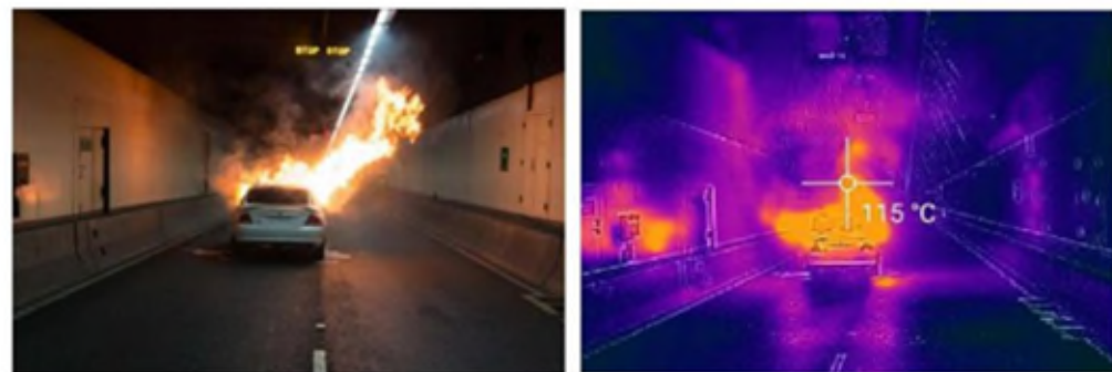
Figura 62: Incendio inicial. En el hastial del túnel se observa una temperatura de 115°C
