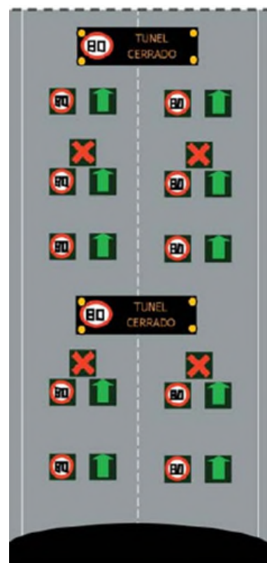
Figura 65: Señalización en un túnel unidireccional (no se considera la señalización en sentido contrario al tráfico)
