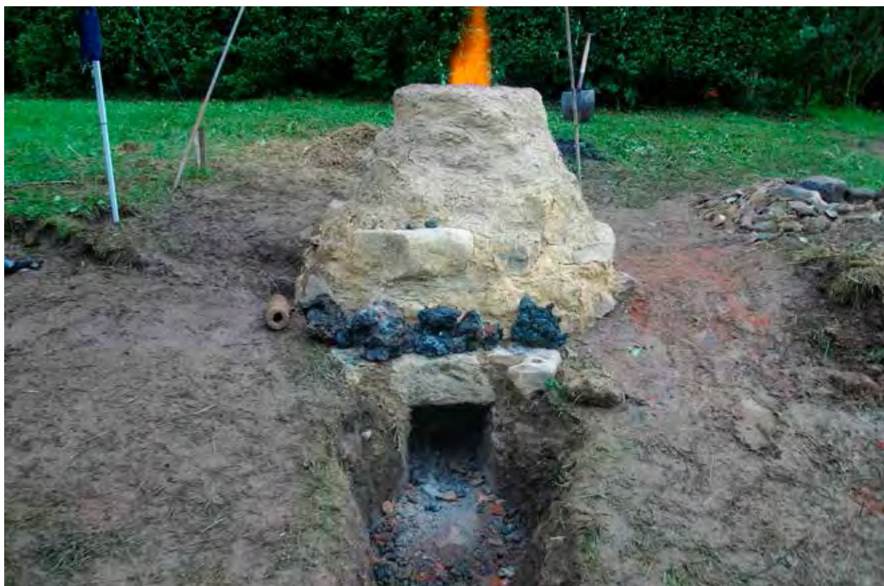
Figura 5. Horno de reducción del Pobal: en él se realizaron las dos primeras sesiones experimentales mediante tiro natural.
