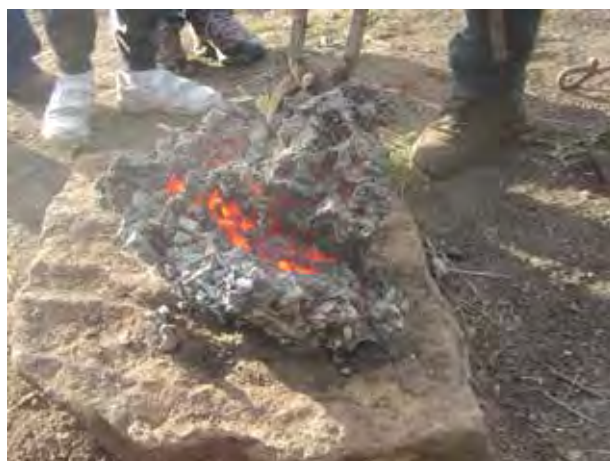
Figura 8. Imagen de la primera lupia escoriácea de hierro obtenida.
