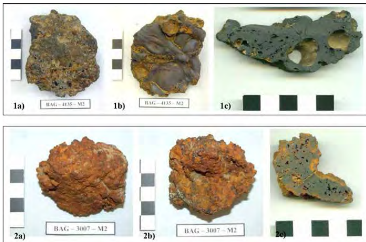
Figura 4. Arriba, fragmento de escoria colada. BAG-4135-M2: 1a) Anverso; 1b) Reverso; 1c) Macrografía de la sección. Abajo, fragmento de escoria interna. BAG-3007-M2: 2a) Anverso; 2b) Reverso; 2c) Macrografía de la sección (Imágenes: Gener y Montero 2012)
