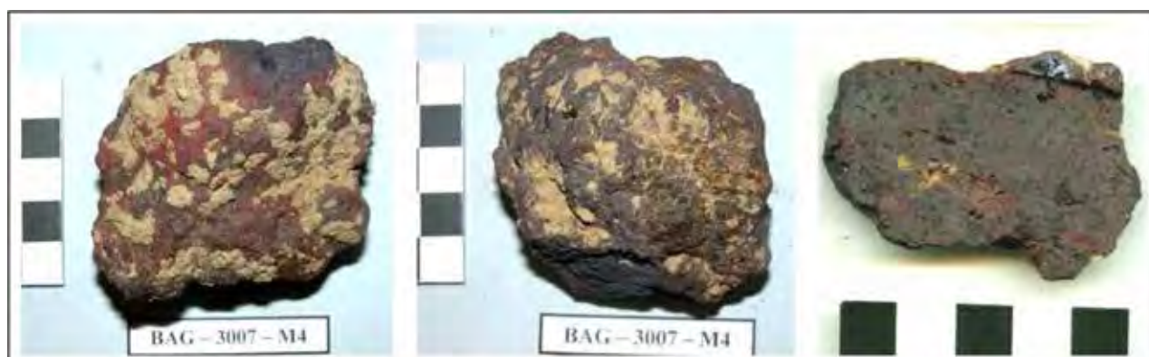
Figura 3. Fragmento de mineral de hierro. BAG 3007 M4: a) Anverso; b) Reverso; c) Macrografía de la sección (Imagen: Gener y Montero 2012)
