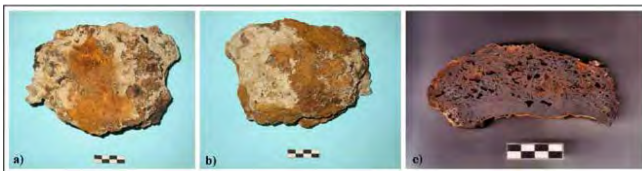
Figura 5. Fragmento de escoria de forja. SMC.18171.1: a) Anverso; b) Reverso; c) Macrografía de la sección (Imagen: Montero y Renzi 2013)
