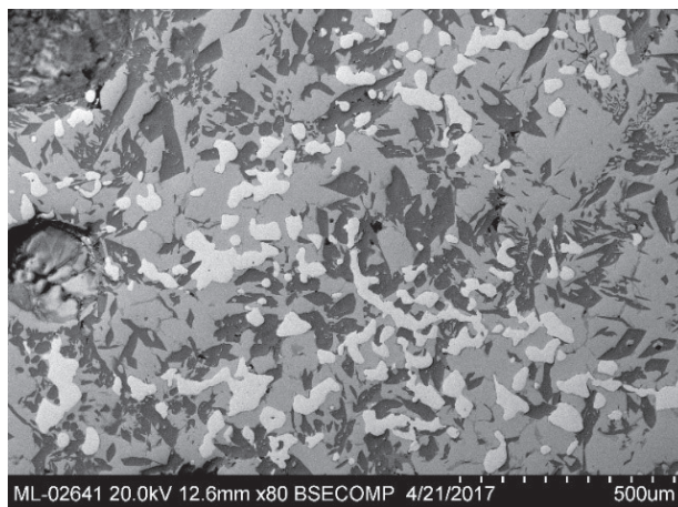
Figura 115. Izda: Lupia (bloque compuesto de escoria y hierro metálico) obtenido en el experimento. Nótese el reflejo metálico del corte realizado. Dcha: Imagen de la microestructura de la parte de la lupia que contiene metal. Los glóbulos de color blanco son de hierro metálico, los cristales poligonales grises son de magnetita y el material intersticial más oscuro es un vidrio rico en calcio. Imagen MEB, electrones retrodispersados.
