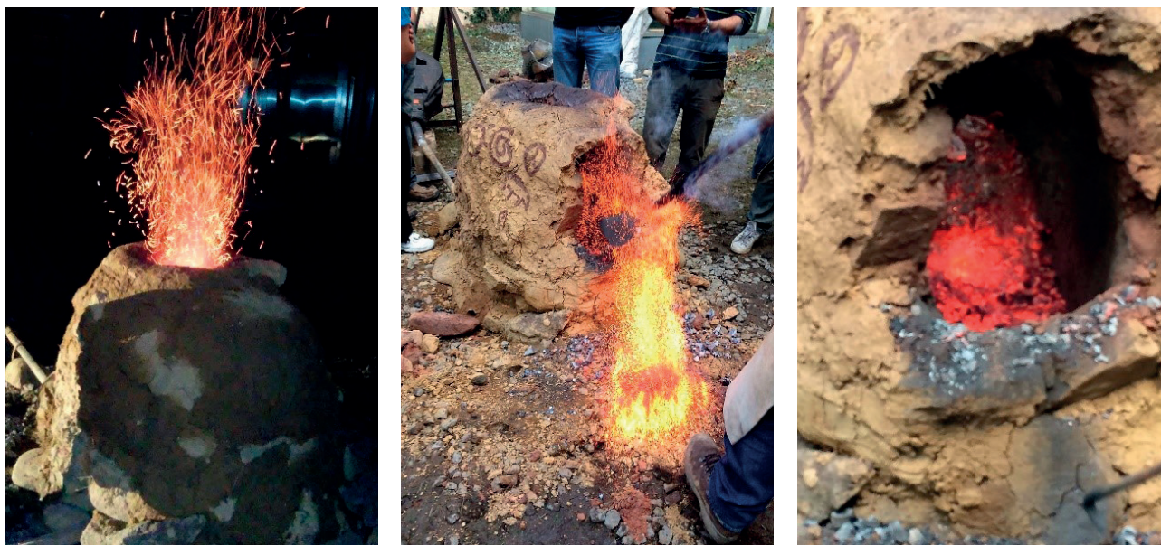
Figura 110. Experimentación en la UNED 2016, Centro asociado de Portugalete. Izda. Encendido nocturno del horno. Centro, Apertura del horno en la pared sobre la rampa interna. Dcha. lupia en el interior del horno.
