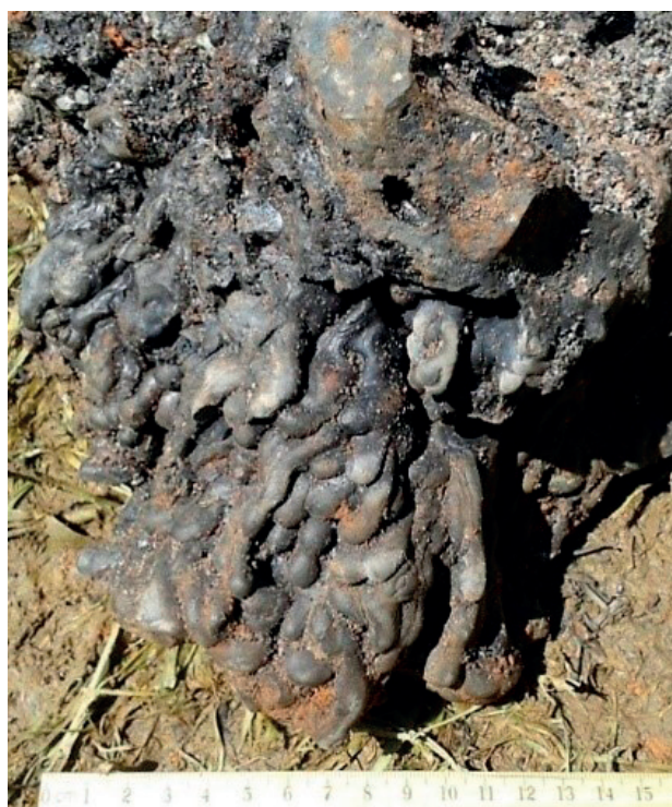
Figura 104. Escoria experimental de sangrado obtenida en el Pobal.
