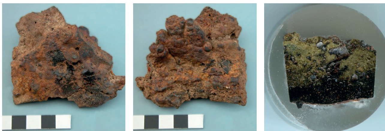
Figura 90. Escoria ARR1 UE 5-2: a) Anverso; b) Reverso; c) Muestra preparada.
