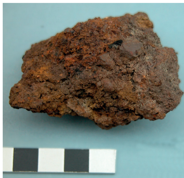
Figura 85. Escoria de afino de procedente del yacimiento de Arrastaleku 1 (Bilbao)
