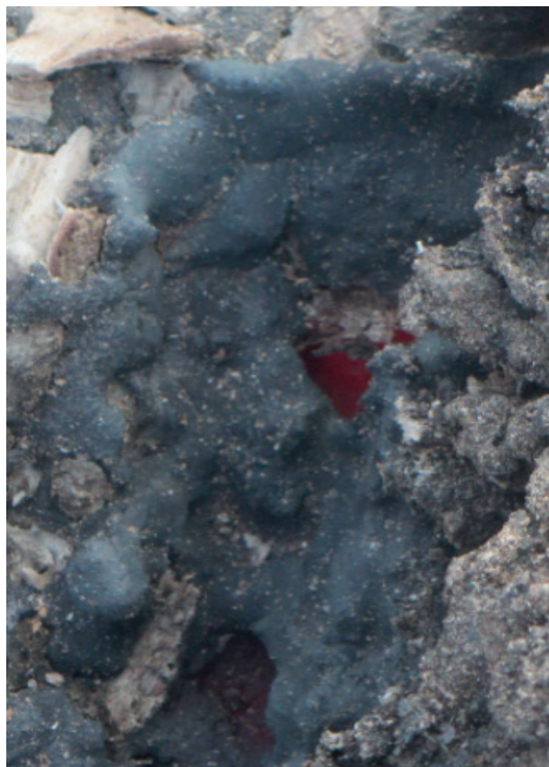
Figura 81. Sangrado producido en el interior del horno. Reducción experimental en el 2014 en el Museo de la Minería del País Vasco.
