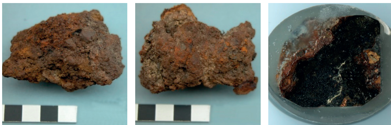
Figura 88. Escoria ARR1 UE 4-3: a) Anverso; b) Reverso; c) Muestra preparada.
