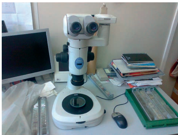
Figura 3. Lupa binocular Nikon SMZ 1500 con base diascópica y sistema de captación de imágenes. A su derecha podemos observar las láminas delgadas preparadas para su archivo.
