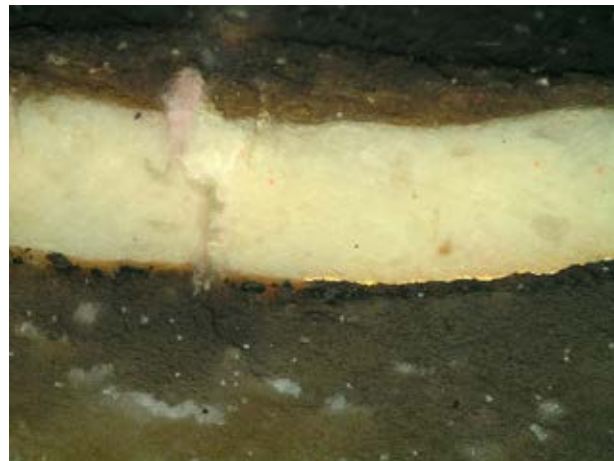
Figura 3. Izquierda (A), dorado sobre asiento de bol de arcilla roja, muestra DT-3, 150 X (lancero de la derecha del sepulcro). Derecha (B), dorado sobre bol de arcilla roja con abundante negro carbón vegetal). Es una ampliación a 300 X de la microfotografía de la muestra DT-8 que aparece en la figura 2.
