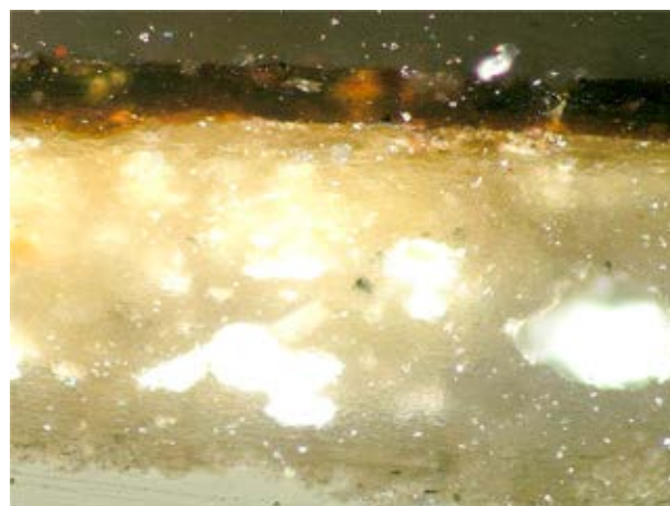
Figura 5. Izquierda (A): Estratigrafía del color rojo con bermellón (muestra DT-1) aplicado directamente sobre la preparación marrón (300 X). Derecha (B): Estratigrafía del color marrón oscuro del hábito de franciscano de don Tello, con un pigmento pardo de tipo orgánico (posiblemente taninos), mezclado con tierras.
