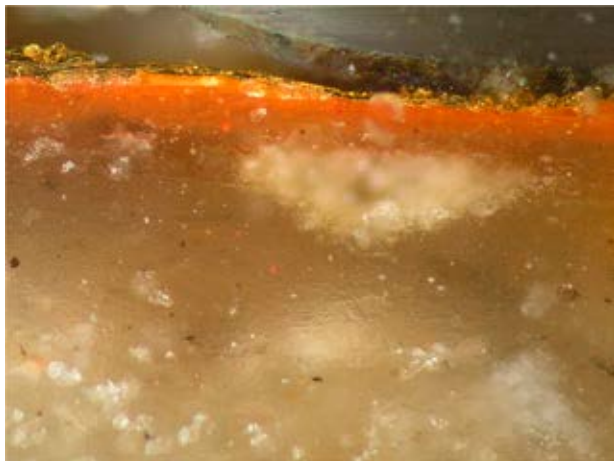
Figura 3. Izquierda (A), dorado sobre asiento de bol de arcilla roja, muestra DT-3, 150 X (lancero de la derecha del sepulcro). Derecha (B), dorado sobre bol de arcilla roja con abundante negro carbón vegetal). Es una ampliación a 300 X de la microfotografía de la muestra DT-8 que aparece en la figura 2.
