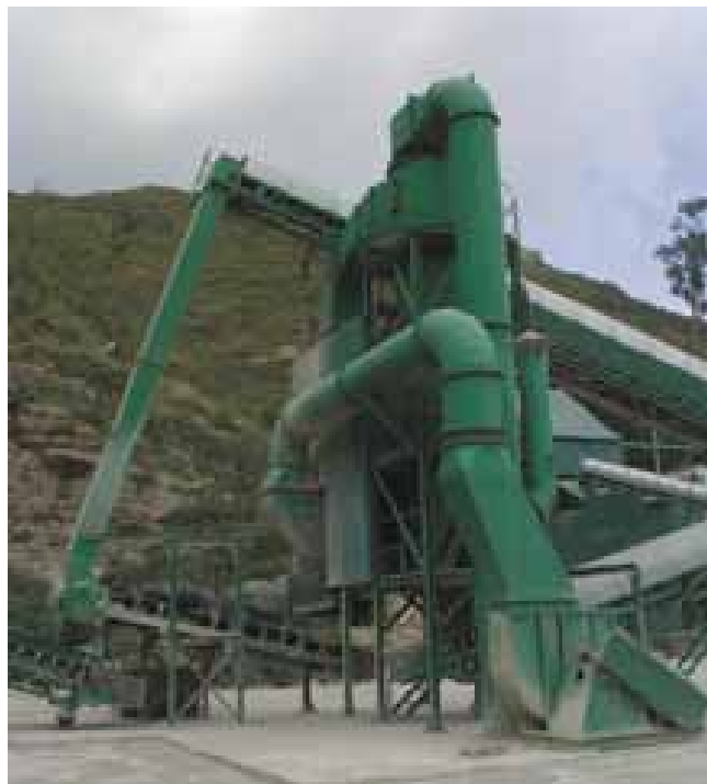
Egurra eta plastikoa bereizteko makineria.
