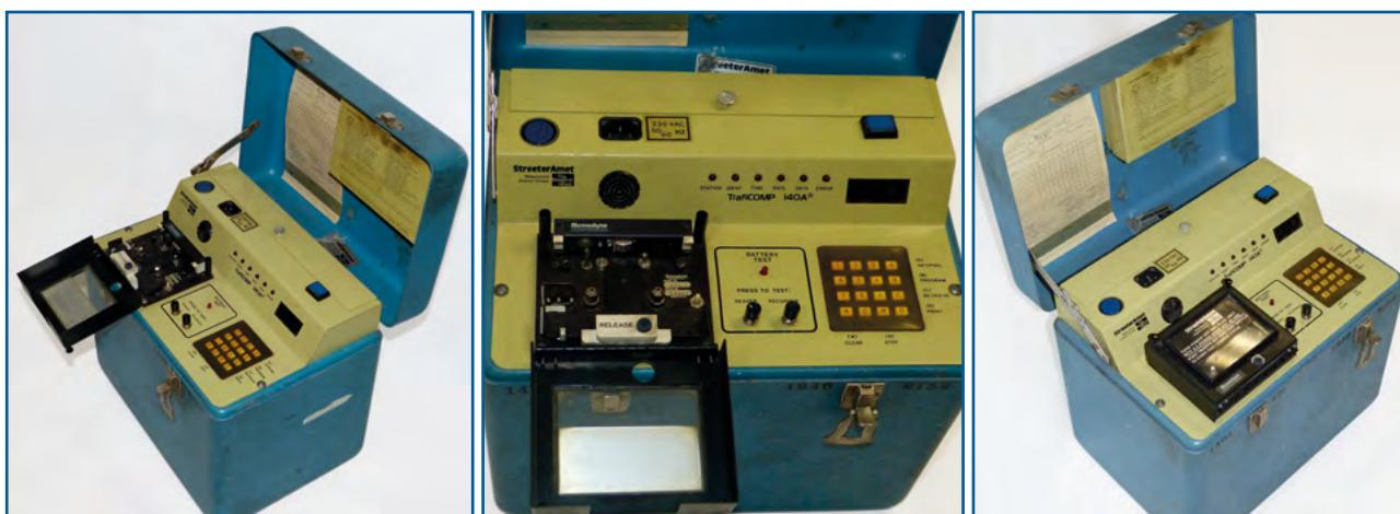
Kalkulu pneumatikoko tresneria / STREETERAMET espira elektromagnetikoak, TRAFICOMP-140A eredua, datuak kasete-zintan biltegiatzen dituenak.
