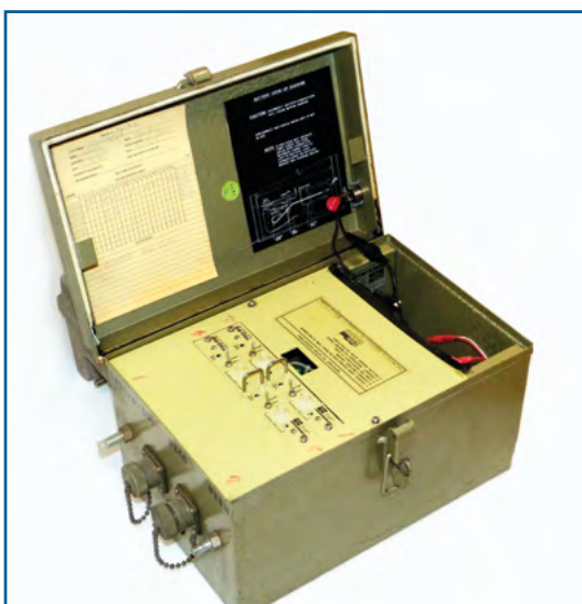
Kalkulu pneumatikoko tresneria / STREETERAMET espira elektromagnetikoak, TRAFICOMP-14,1 eredua, informazioa barnean biltegiratu eta datuak kable bidez PCra transmititzen dituen.
