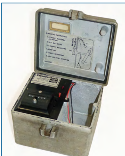
Kanporako kalkulu pneumatikoko tresneria, STREETERAMET, 160-2 eredua, kontagailu mekanikoarekin.
