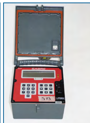
Kalkulu pneumatikoko tresneria / PEEK TRAFFIC espira elektromagnetikoak, ADR-SABRE eredua, datuak USB memoriaren bidez transferitzen dituena.
