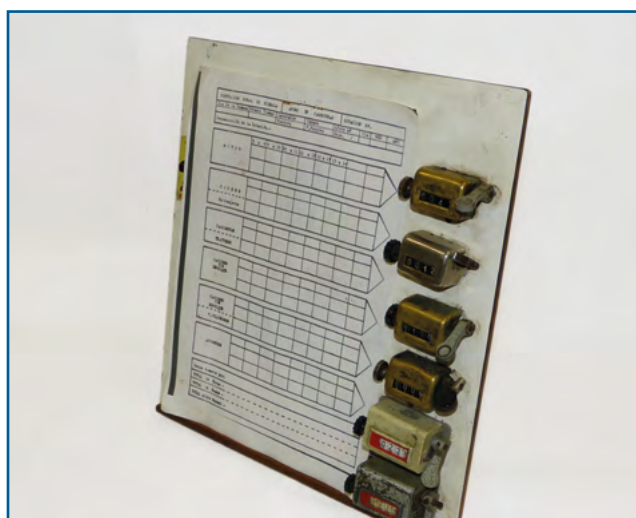
Eskuzko zenbaketak egiteko tresna, ibilgailuak sailkatzeko txantiloiz eta kontagailu mekanikoz osatua.
