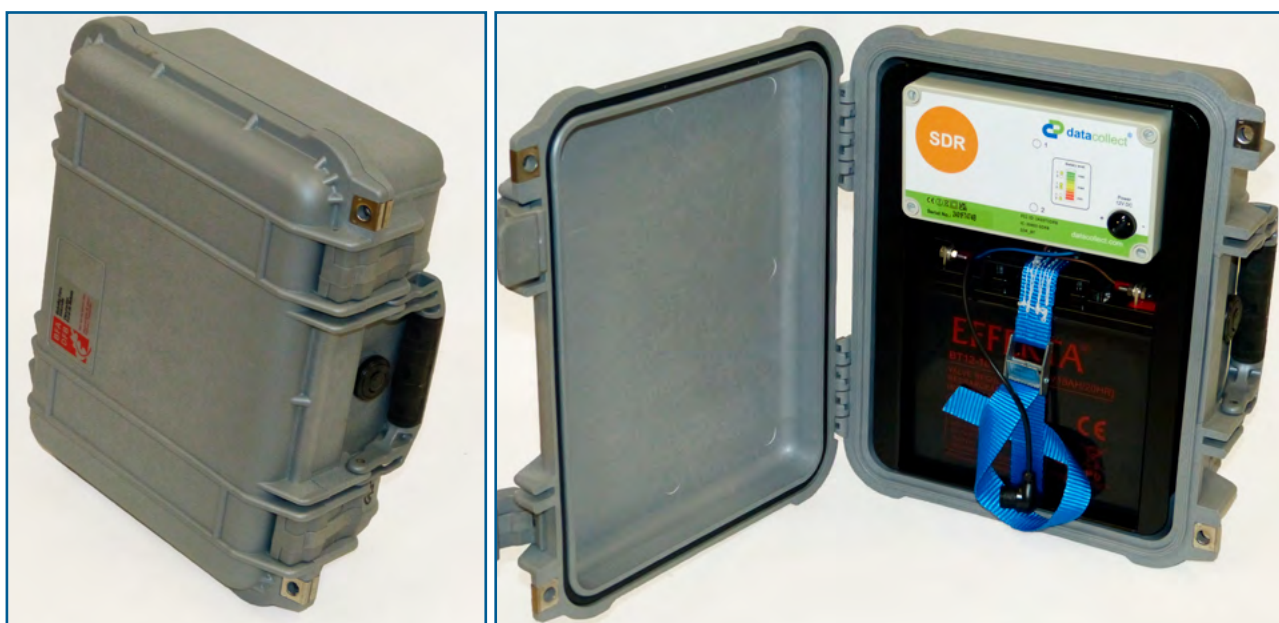
SDR ereduko DATACOLLECT alboko irakurketako radar-teknologiaren bidezko kalkulu tresneria ez-intrusiboa.
