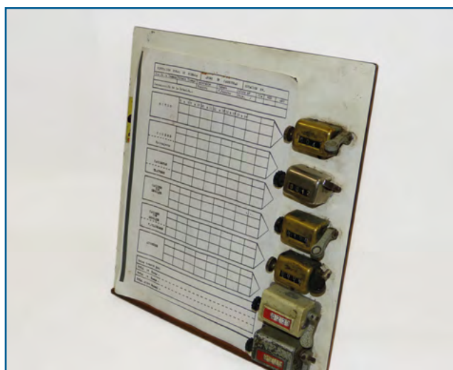
Útil para la realización de conteos manuales compuesto por plantilla de clasificación de vehículos y contadores mecánicos.
