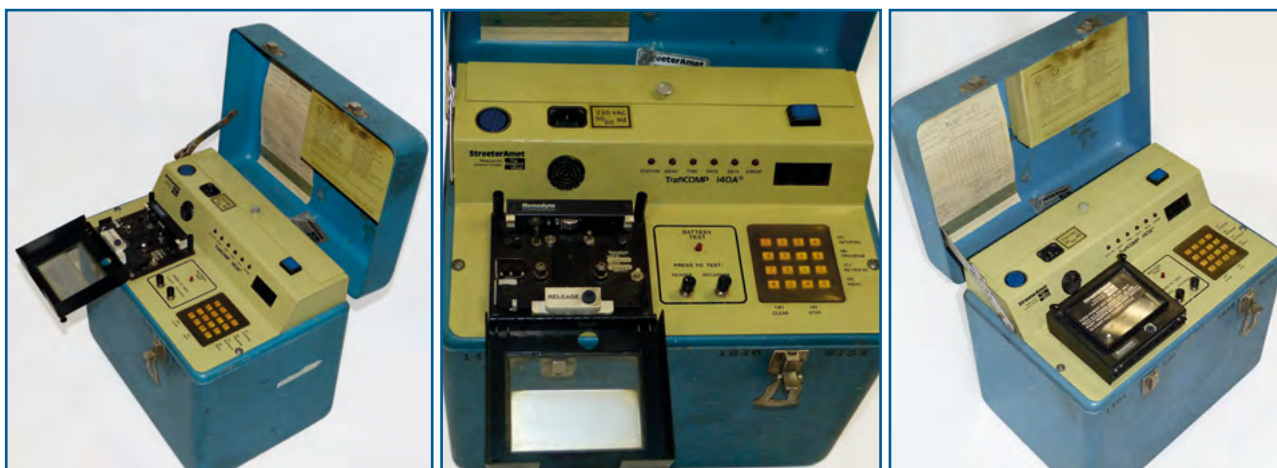
Equipo de conteo neumático/espiras electro magnéticas STREETERAMET, modelo TRAFICOMP-140A, con almacenamiento de datos en cinta de Casete.
