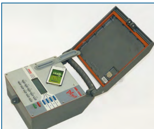
Equipo de conteo neumático/espiras electromagnéticas PEEK TRAFFIC, modelo ADR-1000, con transferencia de datos mediante tarjeta PCMCIA.
