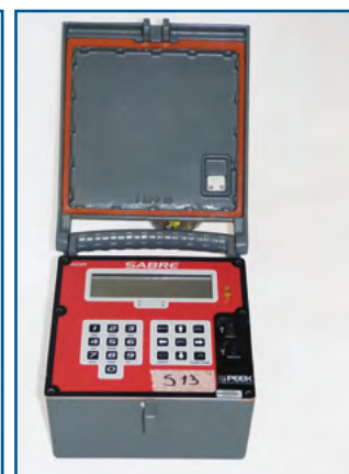
Equipo de conteo neumático/espiras electromagnéticas s PEEK TRAFFIC, modelo ADR-SABRE, con transferencia de datos mediante memoria USB.
