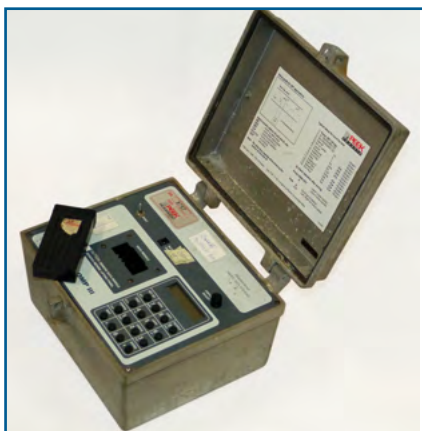
Equipo de conteo neumático/espiras electromagnéticas STREETRAMET, modelo TRAFICOMP-III, con almacenamiento y transferencia de datos en cartucho de memoria.
