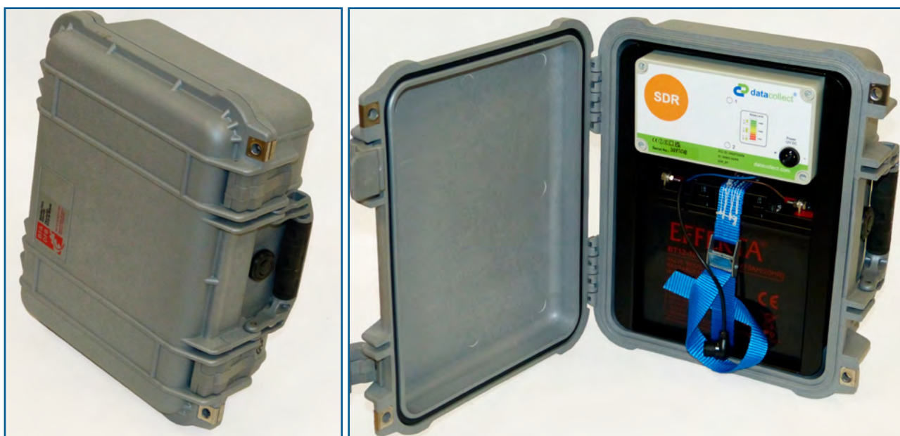
Equipo de conteo no intrusivo mediante tecnología radar de lectura lateral DATACOLLECT modelo SDR.
