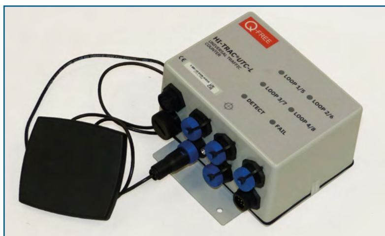
Equipo de conteo espiras electromagnéticas Q-FREE, modelo HI-TRAC-UTC-L, con transmisión de datos por red telefónica con conexión IP.
