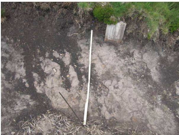
Clavijas instaladas para medir el avance de la erosión
