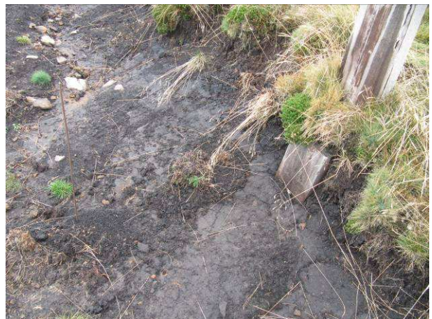
Clavijas instaladas para medir el avance de la erosión
