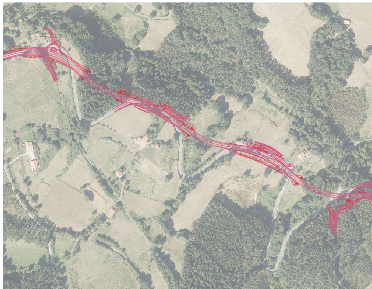
Ilustración nº89: Curvas que serán evitadas mediante viaductos por el proyecto
