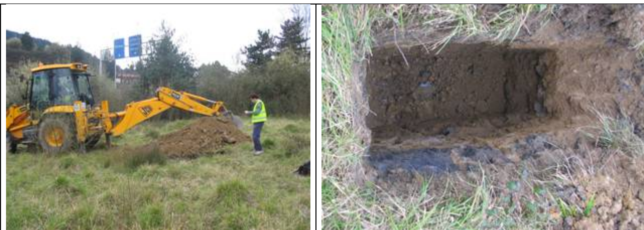
Vista general del emplazamiento y vista en detalle de las paredes de excavación de la calicata C-6
