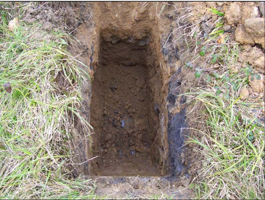
FOTO DE LA CALICATA
