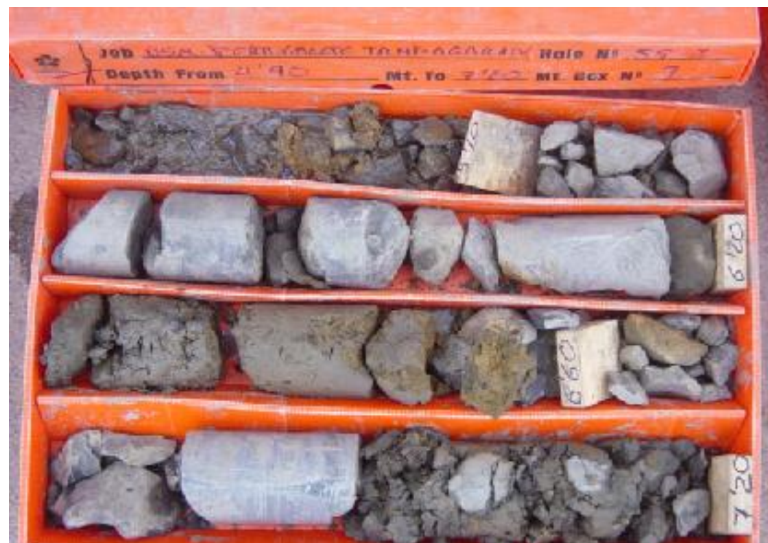
SS-2. Caja 3. De 4,90 m a 7,20 m
