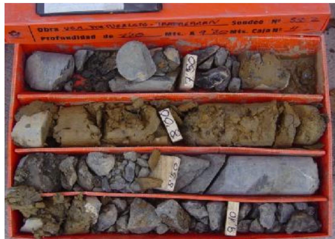
SS-2. Caja 4. De 7,20 m a 9,20 m
