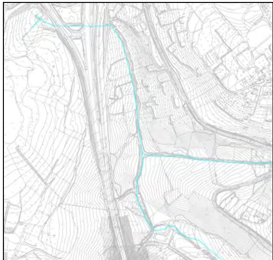
Superposición de la red de drenaje original del año 1965 con la topografía actual
