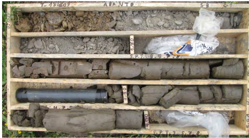
Fotografía 2. Imagen de los suelos coluviales recuperados en el sondeo S-3
