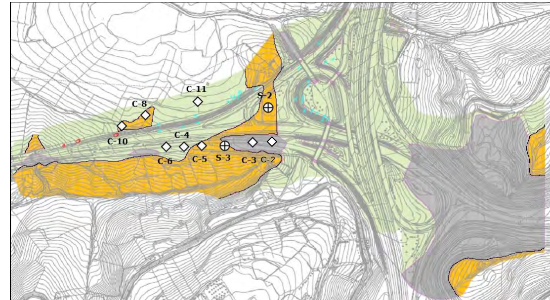
Zonas color naranja, acumulación de suelos coluviales ( e > 1,50 m)
