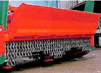
Vista posterior de un modelo de desbrozadora de cadenas con tapa hidráulica abatible.
