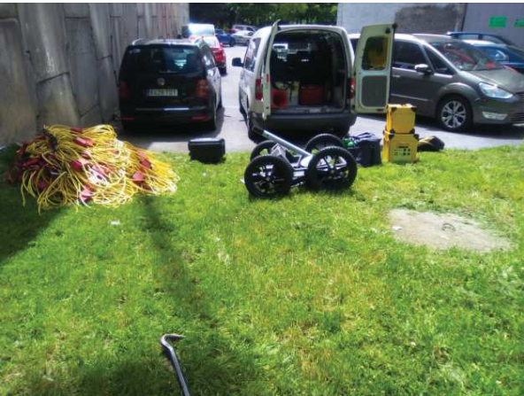
Foto 10.- Fotografía de los equipos utilizados para la tomografía eléctrica y el estudio de geo-radar.
