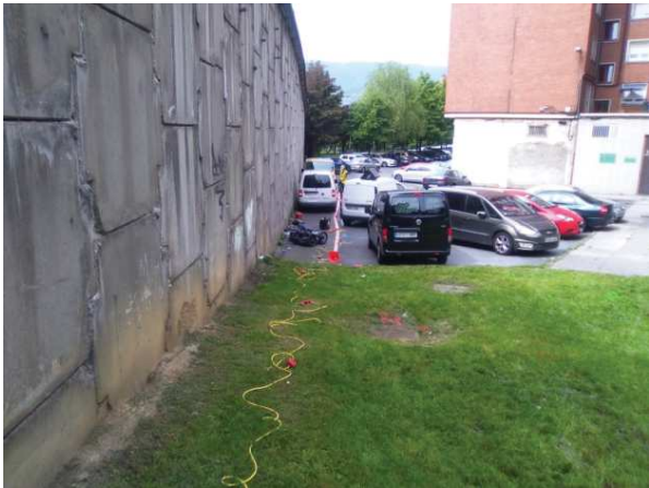
Foto 3.- Imagen del perfil de tomografía eléctrica TME-1, en el que se observa una separación de 2,0 metros respecto al muro de la autopista.
