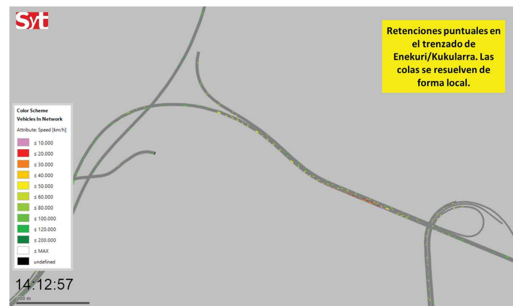
Figura 28: Resultados. Formación de colas. E0 - Trenzado Enekuri/Kukularra.
