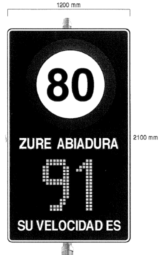
Figura 7: Señal activa de radar a instalar en las bocas del túnel de la Avanzada
