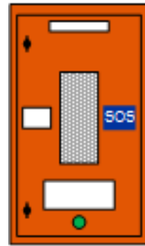
Figura 11: Poste SOS típico de interior de túnel
