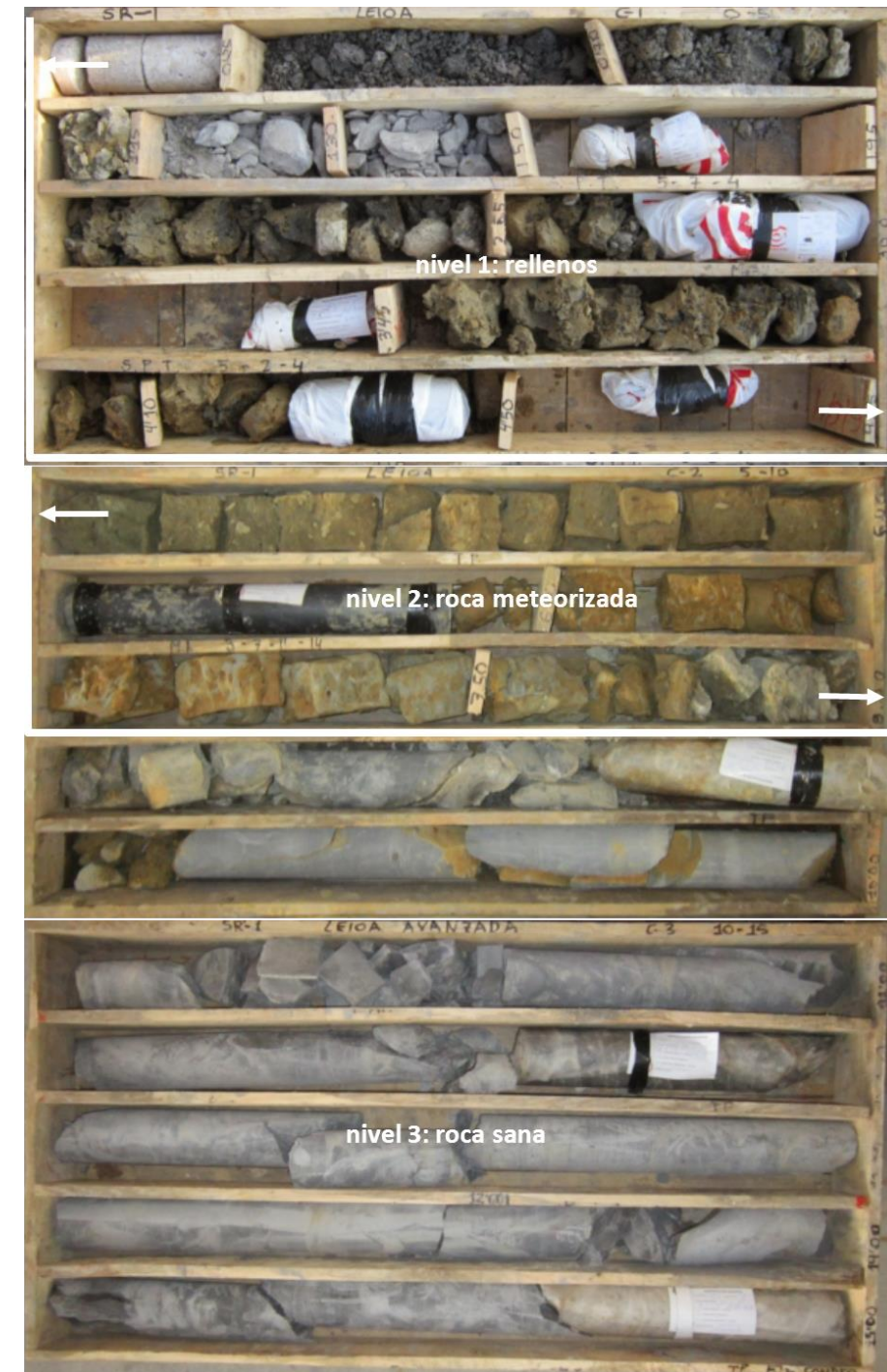
Figura 19: Testigos del sondeo SR-1: Niveles y grados de meteorización
