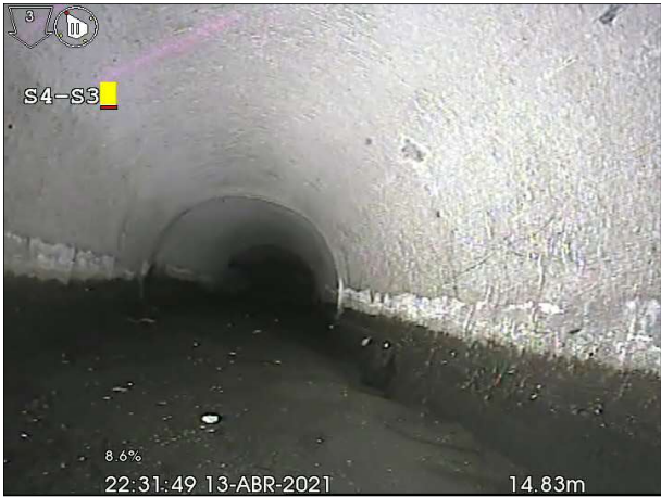
Fotografía: 20b, Nº Video: 5, 00:02:14 13,8m, Sedimentaciones.
