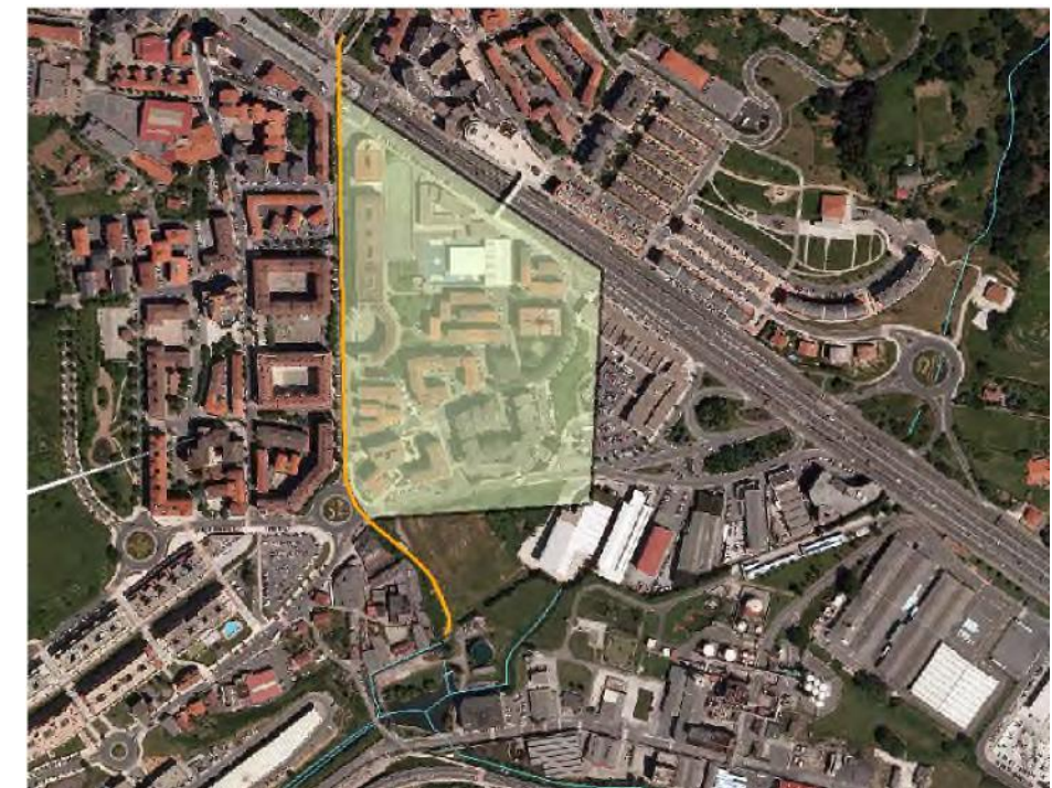
Figura 4: Cuenca de aportación a través de una tubería de diámetro 1.000 mm de la red de saneamiento de Leioa
