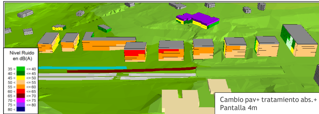
Figura 23: Niveles de ruido en fachada producidos por la carretera BI-637. Solución de proyecto con cambio de pavimento, tratamiento absorbente en túnel y pantalla 4m. Boca Getxo. Periodo noche. Ln
