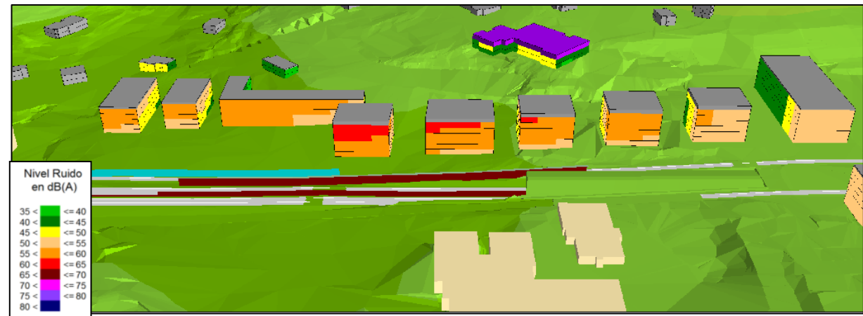
Figura 30: Niveles de ruido en fachada producidos por la carretera BI-637 y vías laterales. Solución de proyecto con cambio de pavimento, tratamiento absorbente en túnel y pantalla de 3m en borde y mediana. Boca Getxo. Periodo noche. Ln
