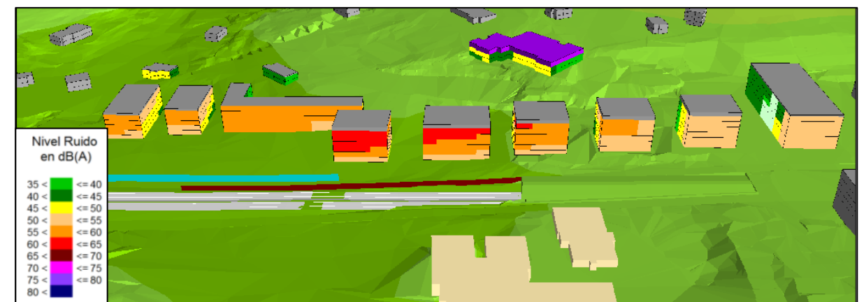
Figura 22: Niveles de ruido en fachada producidos por la carretera BI-637. Solución de proyecto con cambio de pavimento, tratamiento absorbente en túnel y pantalla 3m. Boca Getxo. Periodo noche. Ln
