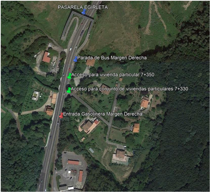
FIGURA 1. Accesos margen derecha. Tramo previo a la pasarela.
