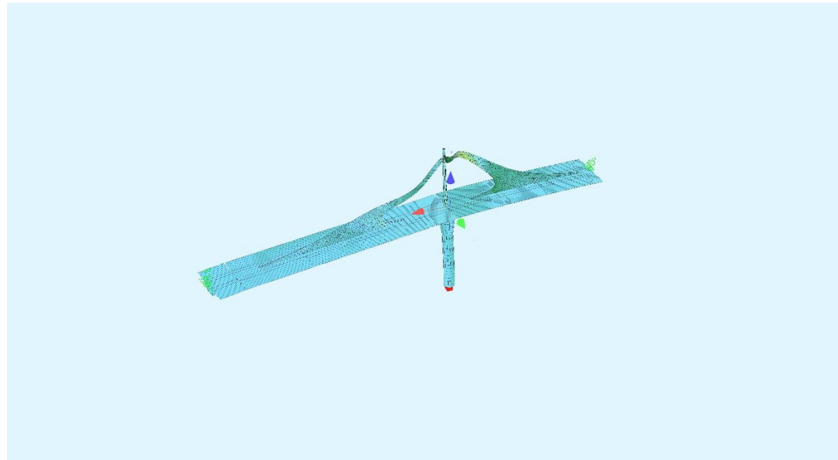
Modo 3 - 1.75 Hz (Horizontal longitudinal)
