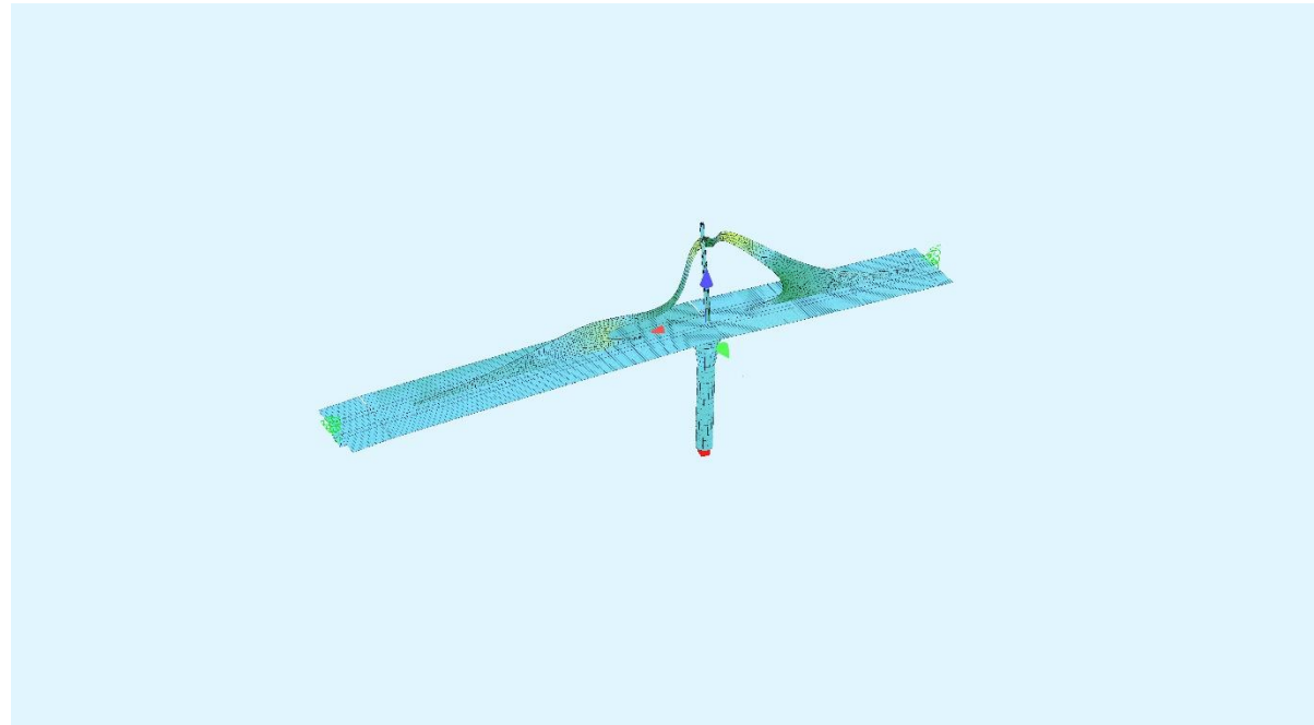
Modo 2 – 1.67 Hz (Horizontal longitudinal-transversal)
