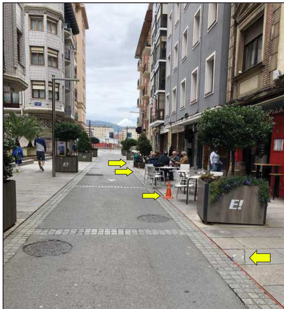
Figura 14: Perfil de tomografía eléctrica Erandio Norte. Se observa en la parte inferior derecha de la fotografía el cable de 90 m tierra adentro (cable de color naranja oscuro) con alguno de los electrodos conectados al terreno (indicados con flechas amarillas).
