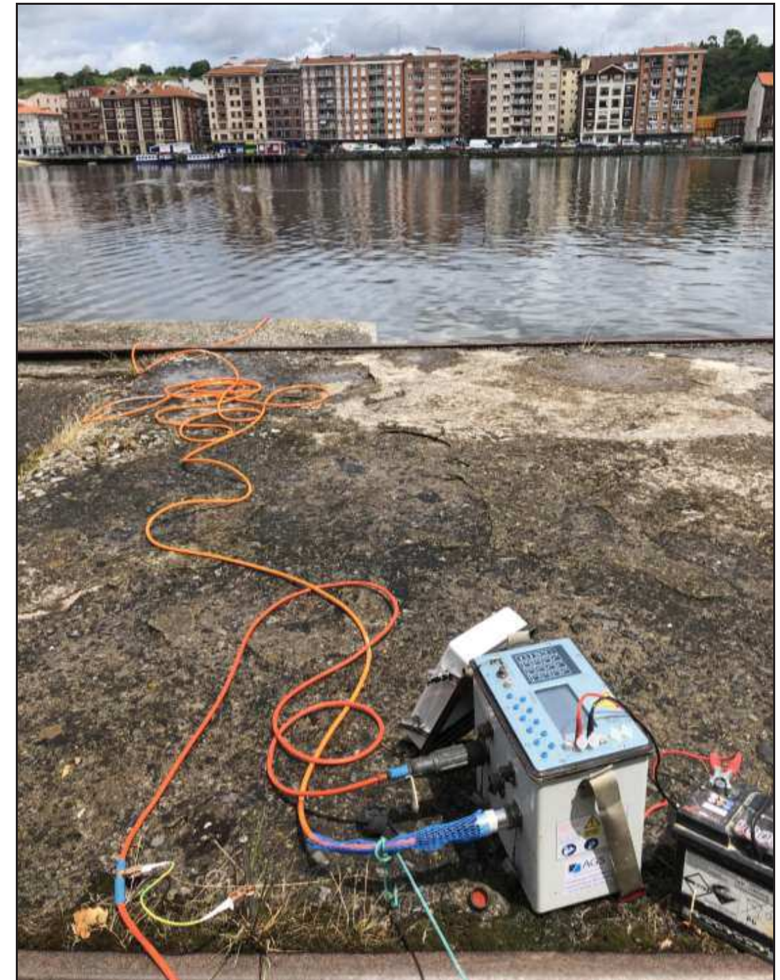
Figura 13: Perfil de tomografía eléctrica Barakaldo Sur. El equipo de medida se sitúa en la orilla y “lanza” el cable de 180 m hacia el agua (cable de color naranja claro) y el cable de 90 m tierra adentro (cable de color naranja oscuro).
