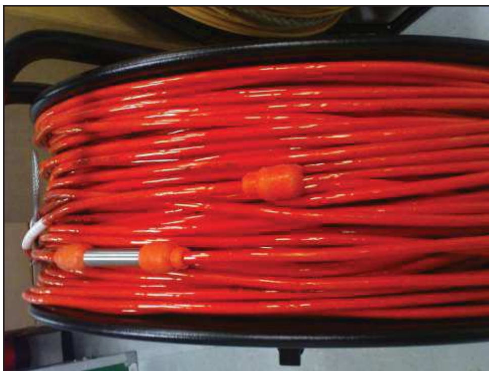
Figura 9. Cable multielectródico sumergible para prospección geoelectrónica. Detalle de una de las 18 conexiones de acero especial de que dispone el cable para la toma de datos.
