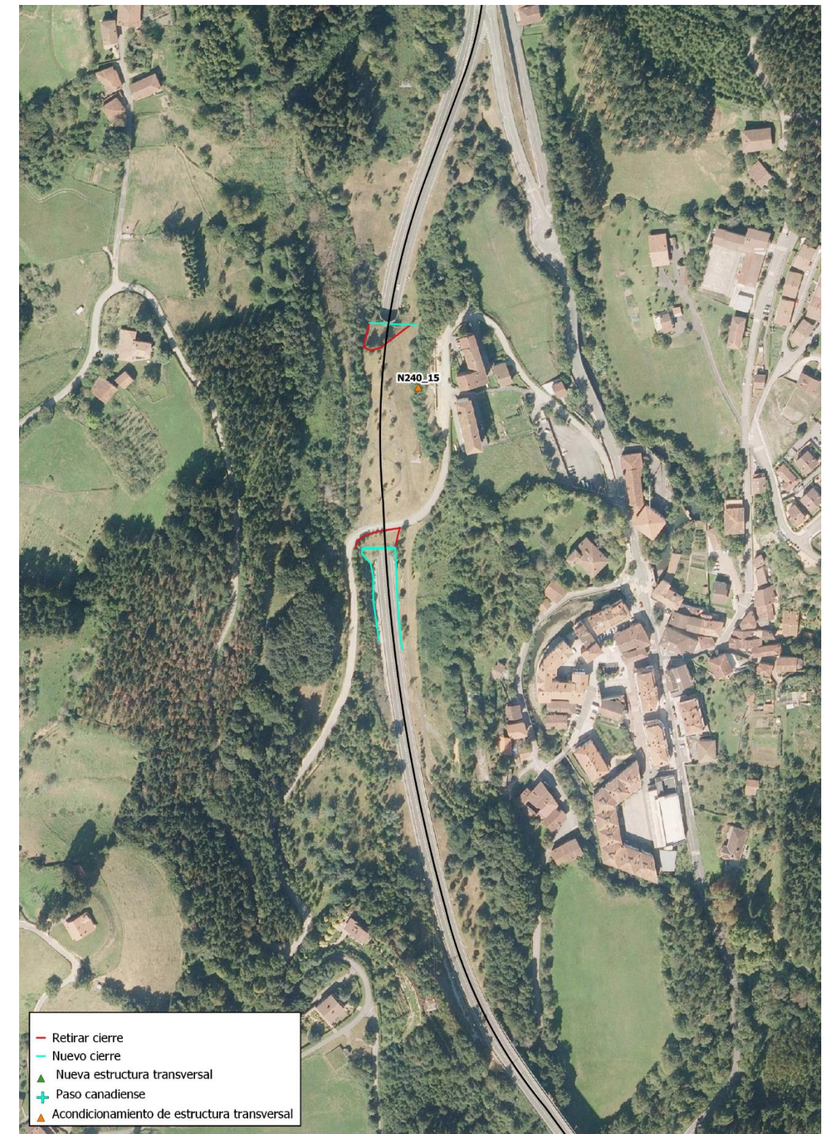
Figura nº39. Actuaciones a realizar en el tramo Zeanuri-Barazar.
