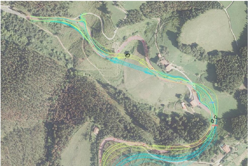
Tomas o depósitos detectados en la visita de campo, marcados en negro
