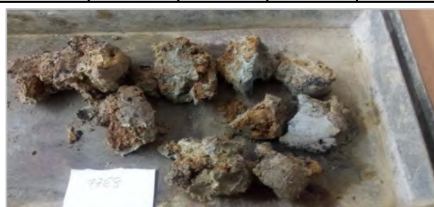
Rellenos antrópicos arcillosos con gravas
