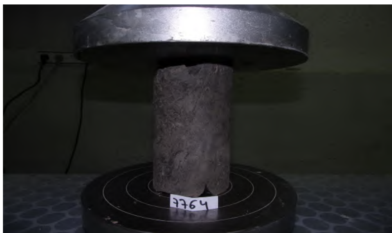
Foto de la rotura en tránsito
