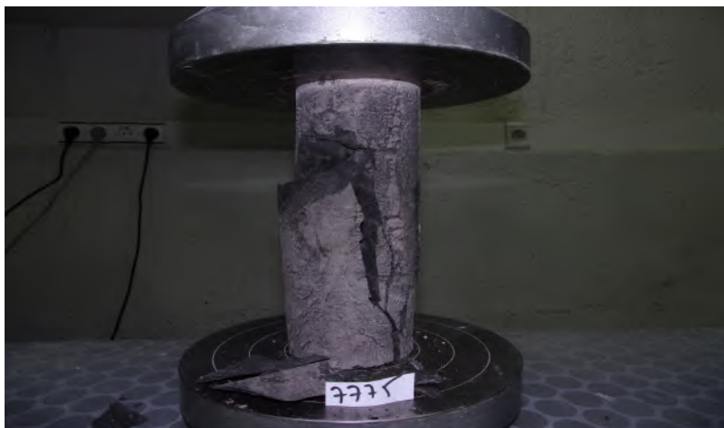
Foto de la rotura en tránsito
