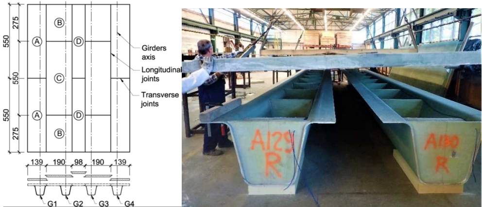
Ejemplo de tablero con vigas de CFRP
