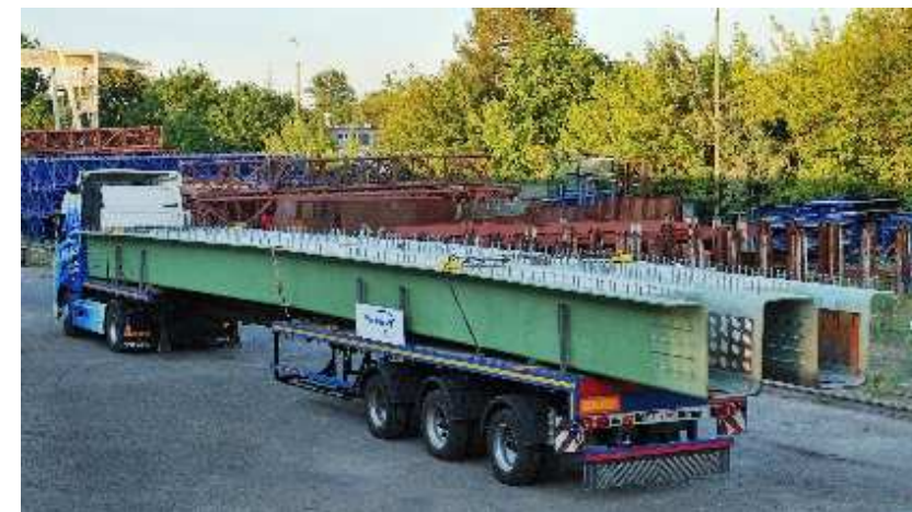
Transporte de vigas de CFRP
