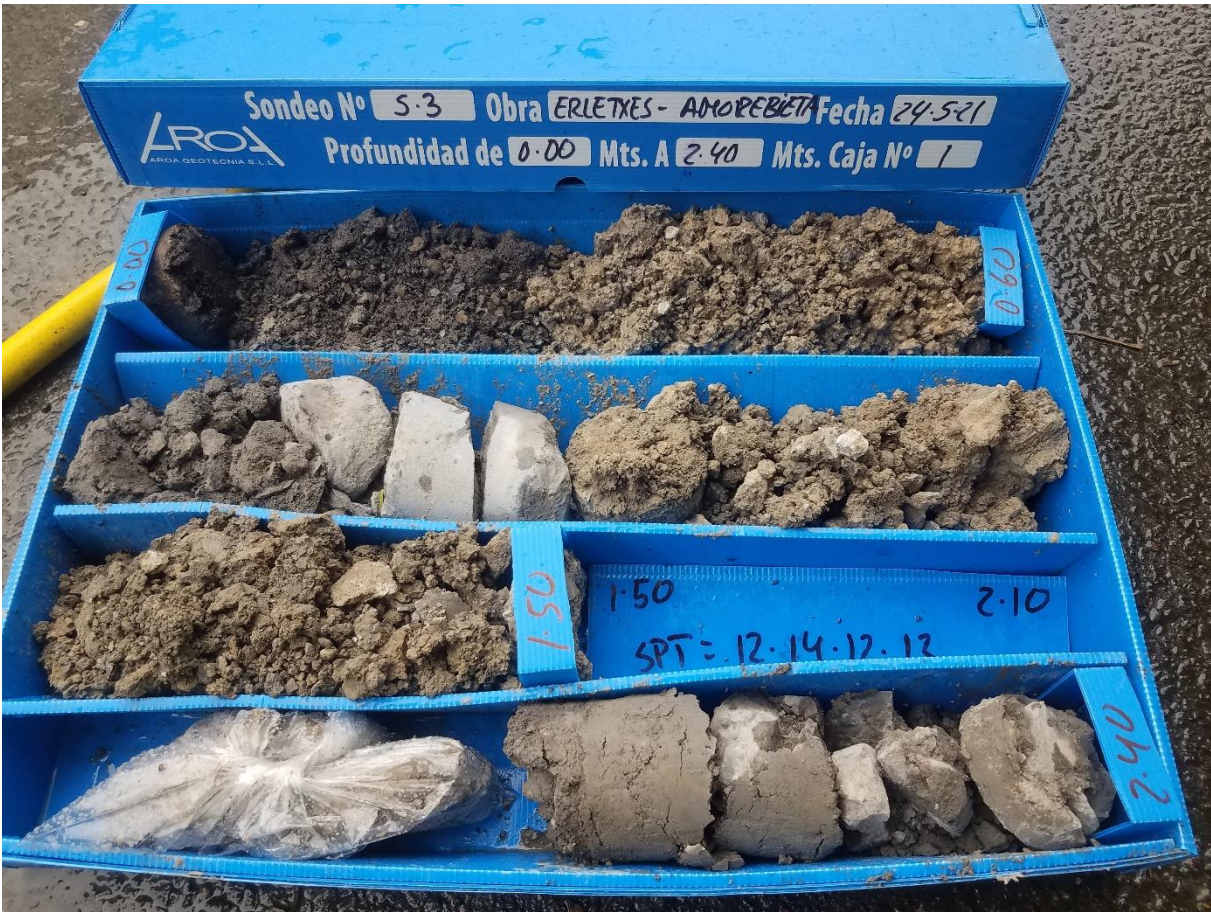
Figura nº1. Aspecto de los rellenos antrópicos ligados a las obras de la Autopista AP-8
