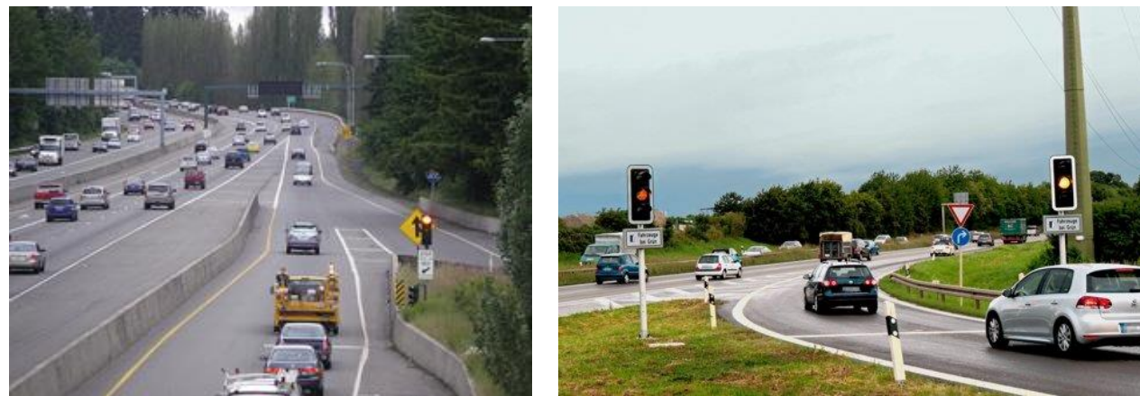
Figura 4. Ejemplo de sistemas de ramp metering
