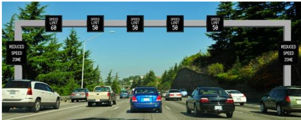
Figura 6. Ejemplo de vía con un sistema de velocidad variable
