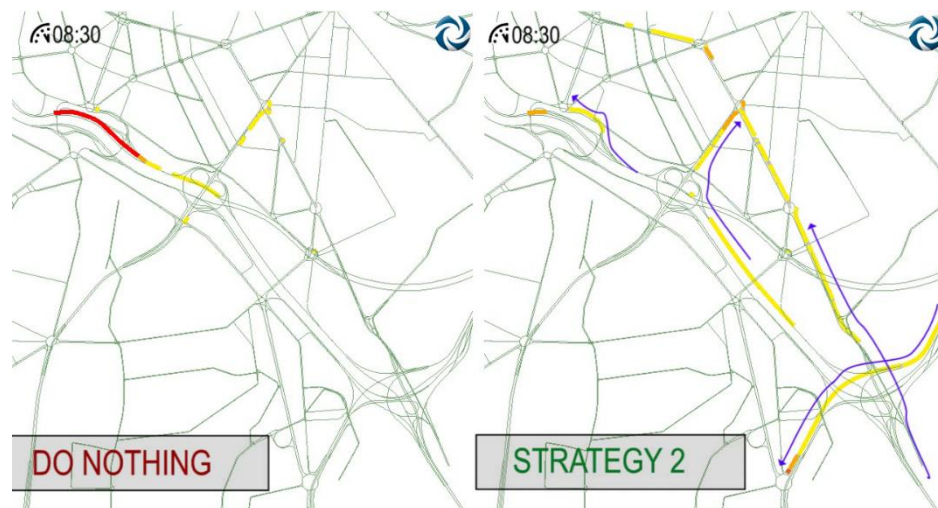
Figura 2. Ejemplo de guiado de tráfico mediante PMV
