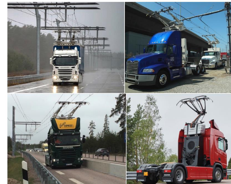
Figura 13. Prototipos de funcionamiento de sistemas ERS mediante catenaria aérea
