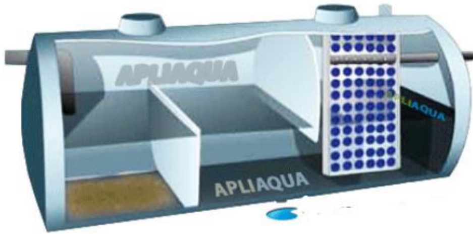
FIGURA 25. DECANTADOR DIGESTOR CON FILTRO BIOLOGICO
