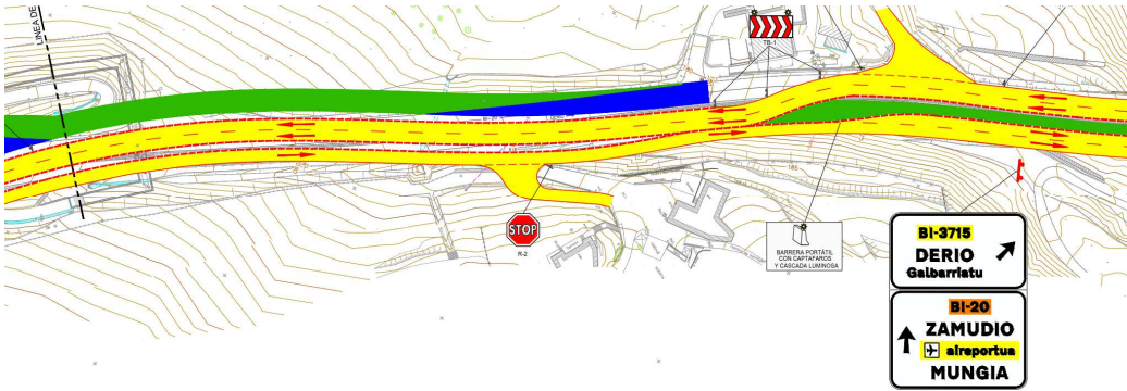
FIGURA 6. Fase-3, tráfico en el tronco sentido Bilbao
