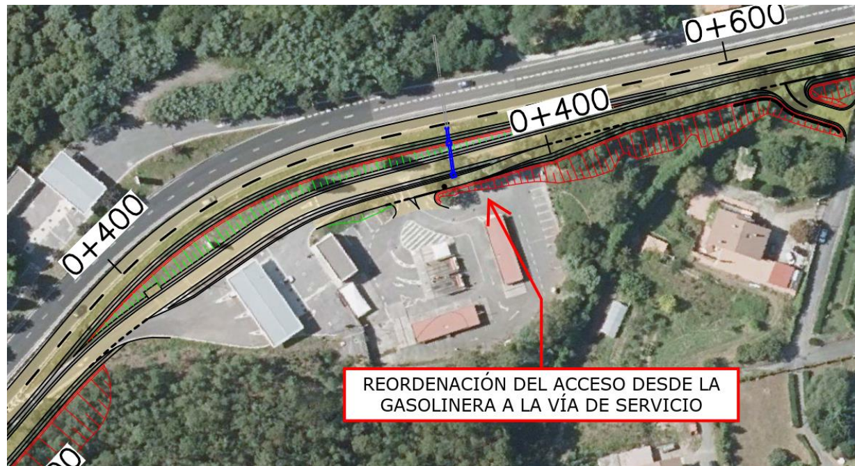
FIGURA 6. INCORPORACIÓN A LA VÍA DE SERVICIO DESDE LA GASOLINERA.
