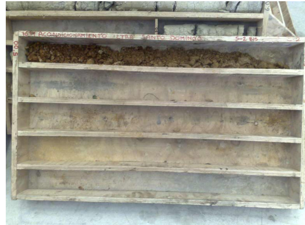
Caja nº2: de 5,00 m a 6,00 m
