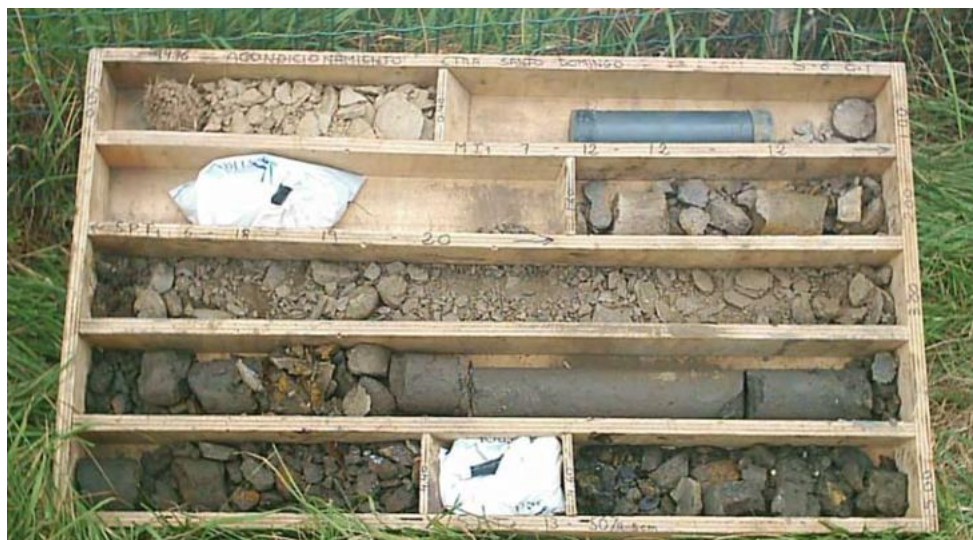
ASPECTO DE LOS SUELOS DE ALTERACIÓN EN LOS METROS SUPERIORES DEL SONDEO S-6.
