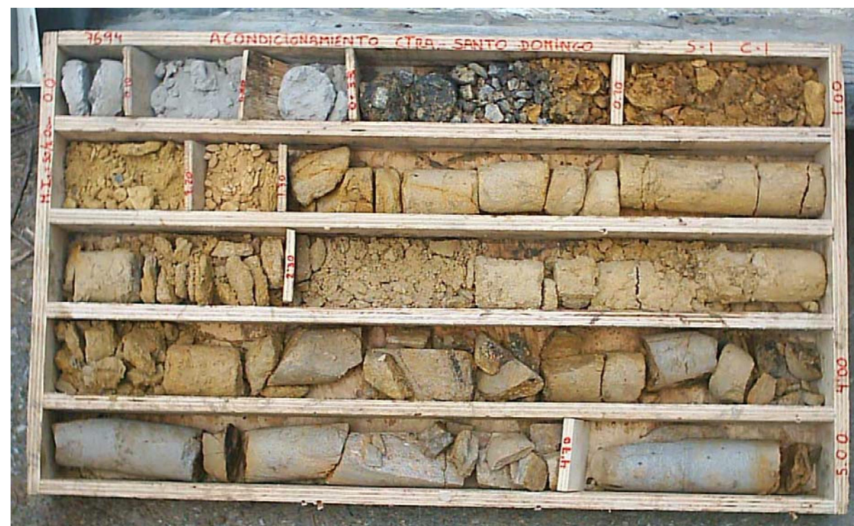
Caja nº1: de 0,00 m a 5,00 m
