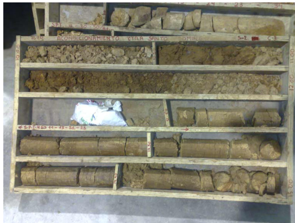
Caja nº3: de 10,00 m a 15,00 m
